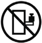
Keine schweren Gegenstände auf Anlagen stellen, die auf einer Gleit-/Schienenvorrichtung montiert sind.
